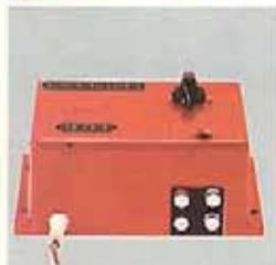
5008 Supertransformator für Großanlagen Innen- und Außen- betrieb Nur zusammen mit Superfahrregler 5012 verwendbar. Anschluß 220 V- regulär Gesamtleistung 3 A, 20 VA Fahrlstrom 14 V/18 V - 2 A Licht- und Schalt- spannung 14 V-, 1 A
